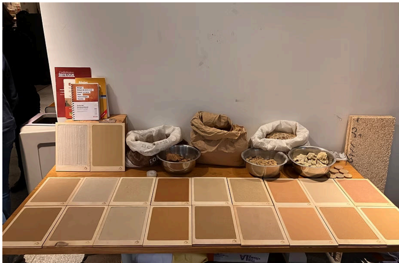
Atelier Terramano, préparation des enduits terres
