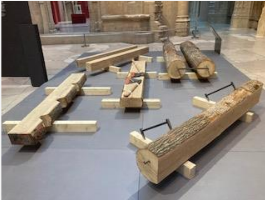
Grumes à différents stades d'équarrissage, doloire et hache de dégrossi
