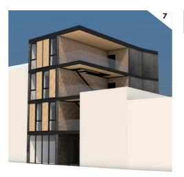
Son principe de construction repose sur un encastrement des modules éliminant clous, vis ou colle du processus d'assemblage. Le choix du bois permet par ailleurs la mise en oeuvre d'un cercle écologiquement responsable, l'isolation étant contenu dans l'épaisseur des modules et réalisée à base de copeaux de bois et de chaux. L'habitat pouvant être démonté et remonté d'une tout autre façon, elle lui assure une potentialité d'utilisations dans le temps considérable (7).
